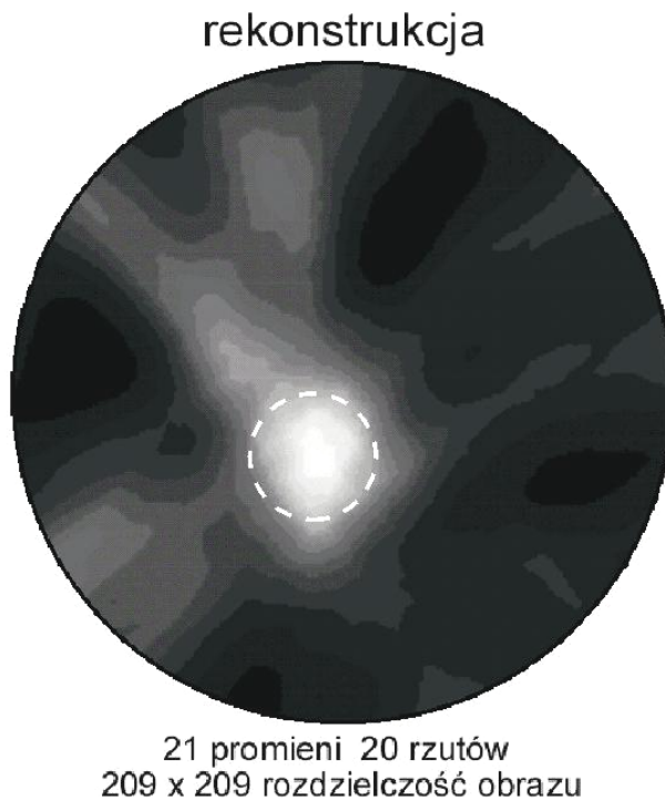
Rys.7. Obiekt mierzony w powietrzu – kołowy wycinek powierzchni płyty aluminiowej z otworem (obszar otworu zaznaczono linią przerywaną).
