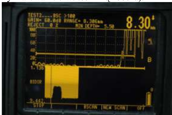
Rys.11. Zobrazowanie ekranu w aparacie Epoch 4 dla wybranego położenia echa dna (lewy) oraz echa wady dużej (prawy) profilu grubości (A + B-scan)
