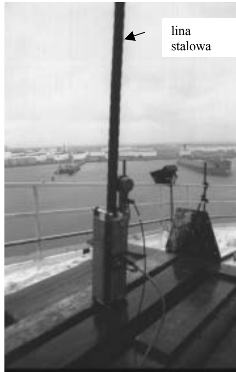
Rys.7. Badanie liny podnoszącej o dużej średnicy na statku do stawiania platform wiertniczych.
