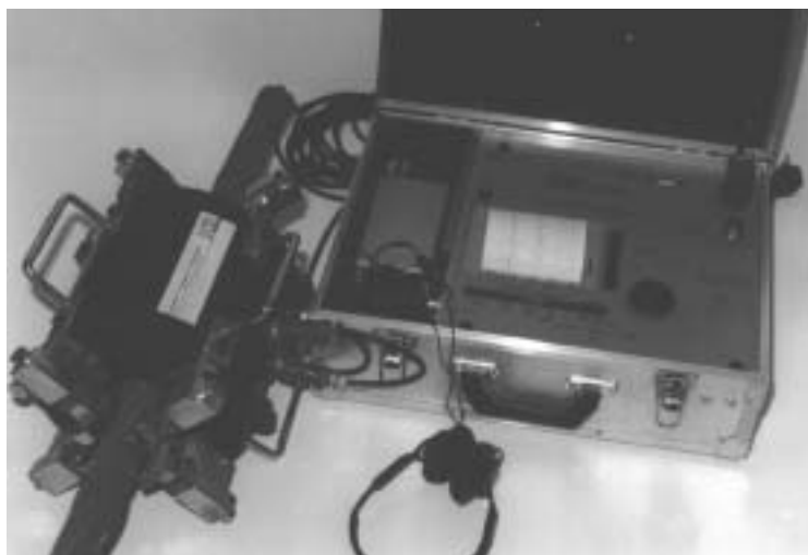
Rys.1. Zestaw do badania lin stalowych (defektograf MD 120 i głowica GM60).
