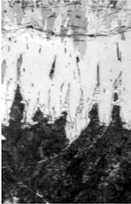
Rys. 1 Zgląd poprzeczny warstwy borowanej na stali. Widoczne charakterystyczne igły borków żelaza [2]
